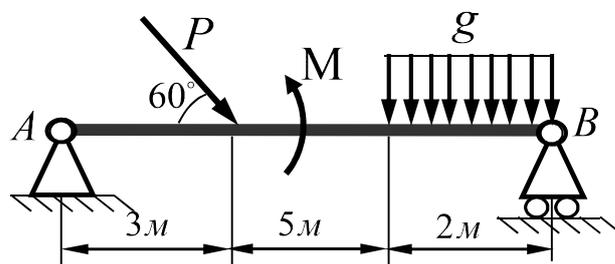
3. Определить реакции опор заданной конструкции, если  $M = 6 \text{ кН} \cdot м$ ,  $F = 3 \text{ кН}$ . Необходимые размеры указаны на рисунке.
