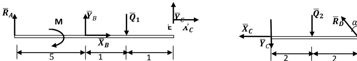
При направлении составляющих  $\bar{X}_c$  и  $\bar{Y}_c$  для левой и правой балок учтён принцип равенства действия и противодействия. Вычисленные силы:
