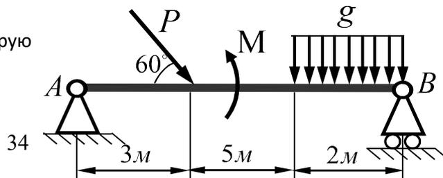
$$P = 5 \text{ кН} , \quad g = 2 \text{ кН/м} \quad M = 10 \text{ кН} \cdot \text{м}.$$
