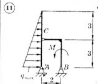
$M = 20 \text{ кН}\cdot\text{м}; q_{\text{max}} = 40 \text{ кН/м}$
