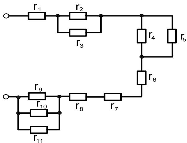
$r_1 = 2 \text{ Ом} ; r_2 = 1,3 \text{ Ом} ; r_3 = 5 \text{ Ом} ; r_4 = 7 \text{ Ом} ; r_5 = 3,7 \text{ Ом} ; r_6 = 10 \text{ Ом} ; r_7 = 9 \text{ Ом} ; r_8 = 11 \text{ Ом} ; r_9 = 9 \text{ Ом} ; r_{10} = 3 \text{ Ом} ; r_{11} = 4 \text{ Ом}$ .
