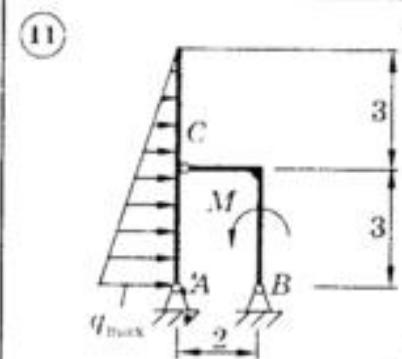
$M = 20 \text{ kH}\cdot\text{m}$ ;  $q_{\max} = 40 \text{ kH}/\text{m}$
