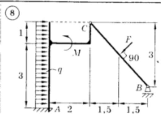
$M = 11 \text{ kH}\cdot\text{m}$ ;  $q = 4 \text{ kH}/\text{m}$ ;
