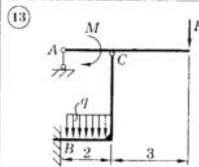
$M = 40 \text{ kH}\cdot\text{m}$ ;  $q = 20 \text{ kH}/\text{m}$ ;
