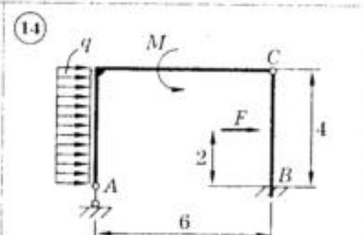
$M = 40 \text{ kH}\cdot\text{m}$ ;  $q = 10 \text{ kH}/\text{m}$ ;
