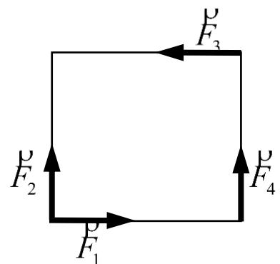
4. К квадрату приложена система четырёх сил, причём силы  $F_1 = F_2 = F_3 = 1H$ . Определить модуль силы  $F_4$ , при которой равнодействующая системы  $R = 2H$ .
