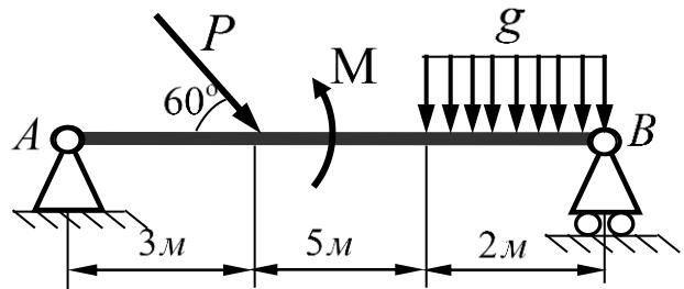
3. Определить реакции опор заданной конструкции, если  $M = 6\text{kH}\cdot\text{m}$ ,  $F = 3\text{kH}$ . Необходимые размеры указаны на рисунке.
