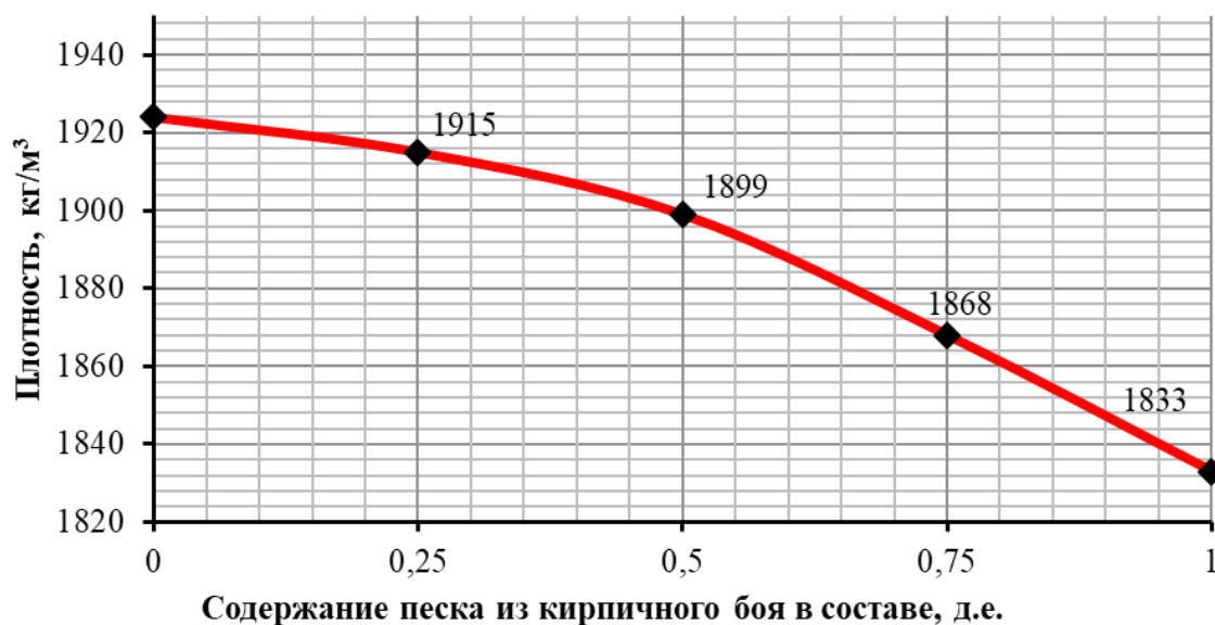
Рис. 1. – Зависимость плотности от вида и количества применяемого заполнителя
