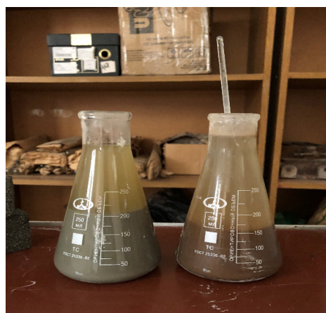
Рис. 1. Снимки щелочных растворов на основе кварцевого песка и вулканического туфа, через сутки (а) и через неделю (б)
