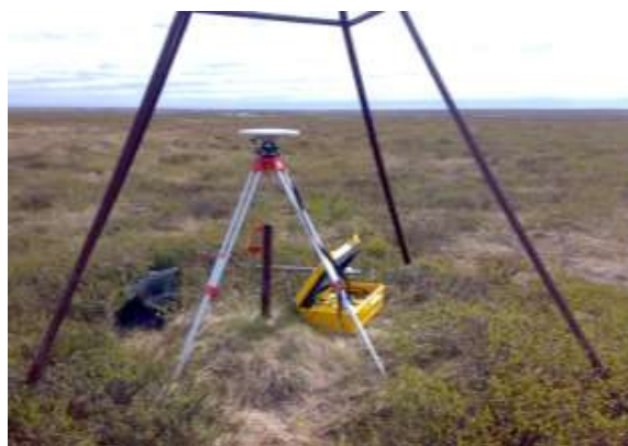
Рис. 6. – Положение антенны над точкой при статической съемке
