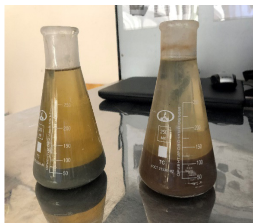
Рис. 1. Снимки щелочных растворов на основе кварцевого песка и вулканического туфа, через сутки (а) и через неделю (б)
