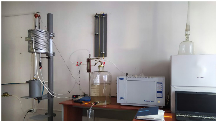
Рис. 3. Экспериментальная установка по исследованию адсорбции
