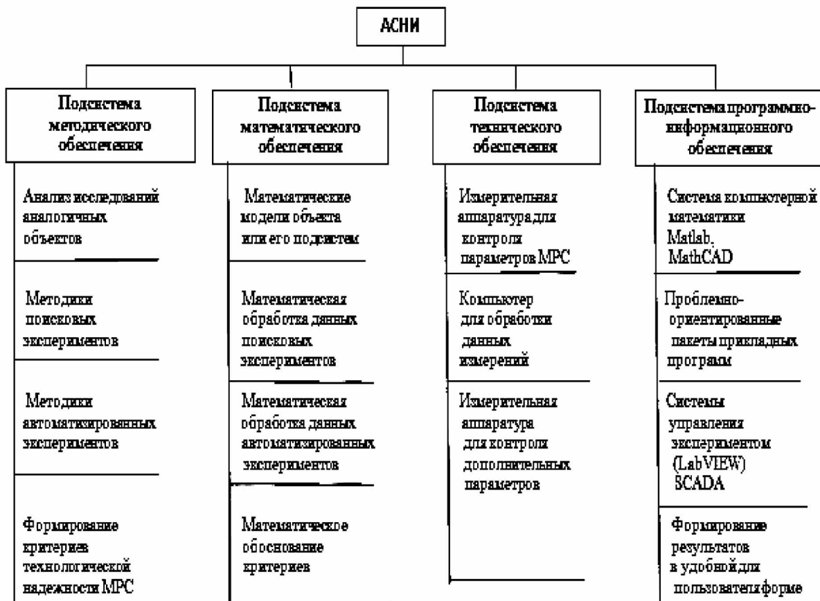
Рис. 2 Структура АСНИ при контроле и испытаниях высокоточных станков на технологическую надёжность в производственных условиях
