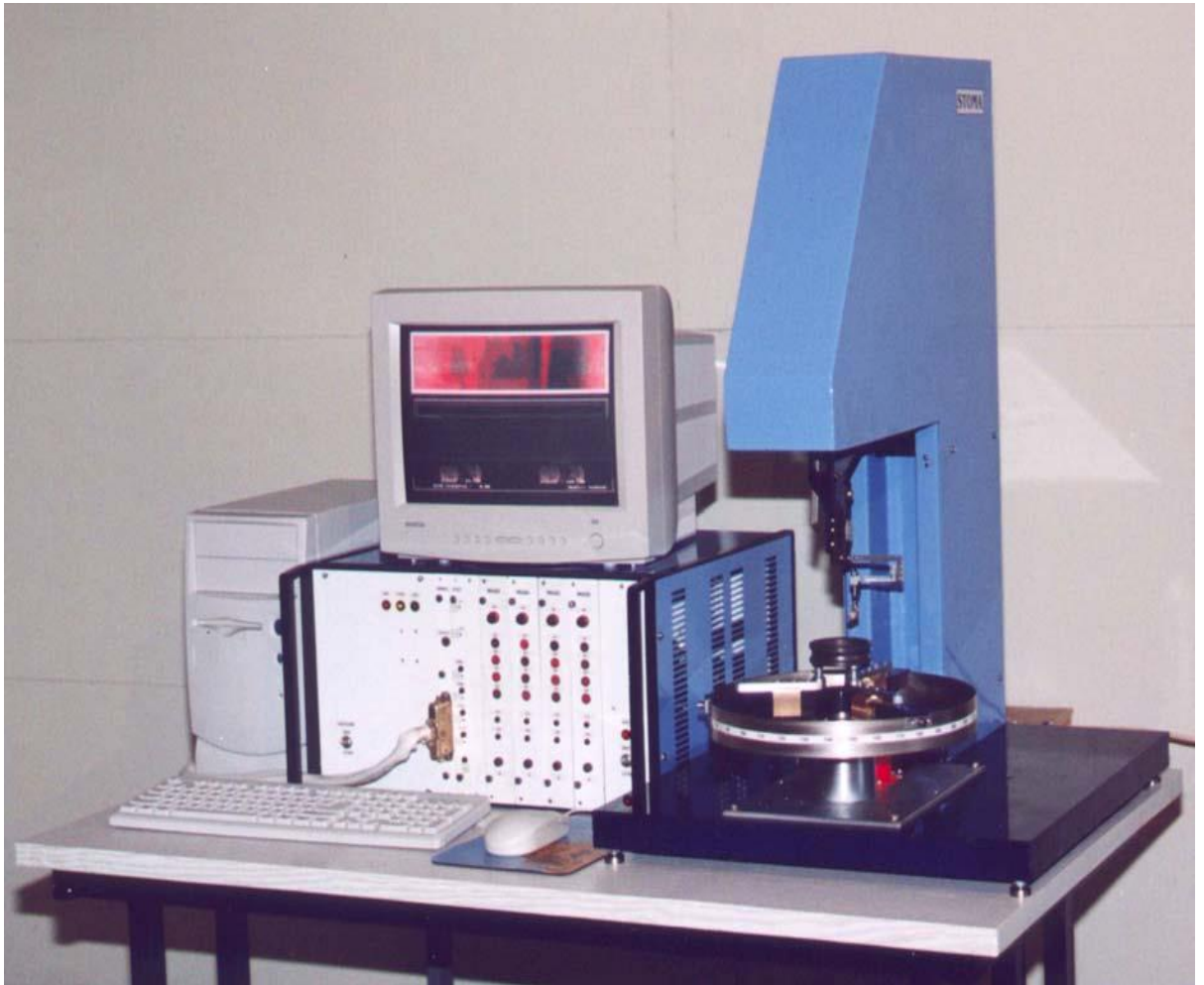
Рисунок 4.1 – Автоматизированный прибор вихретокового контроля ПВК-К2М
