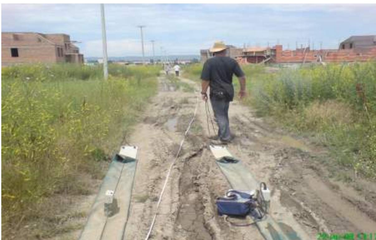
Рис. 3.5 – Рабочий момент проведения георадарной съемки
