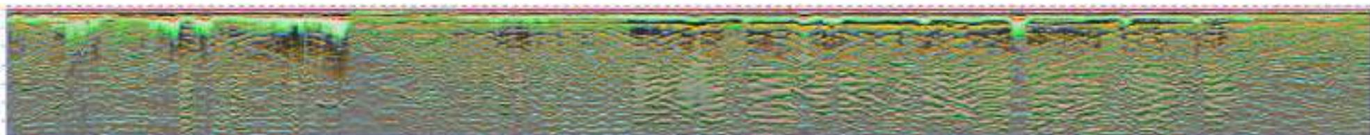
Общая протяженность профиля – 1036 м, глубина зондирования – 1024 ns, шаг фиксации – 20 см, частота зондирования – 50 МГц (георадар «ЛОЗА-Н» в варианте с антеннами – 300 см)
