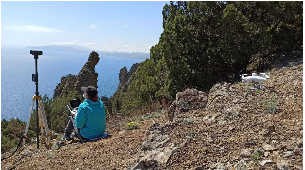
Рисунок 2.10 – Организация тестового полета с использованием квадрокоптера DJI P4 Multispectral на открытом участке около можжевельного леса
