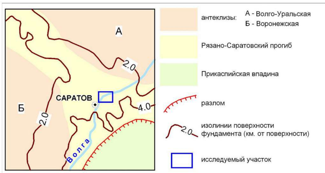
Рисунок 2.1 Схема расположения основных геоструктур Русской плиты в районе исследований (составлено автором по источнику [30])
