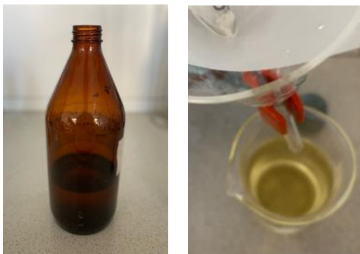
Рисунок 3.10 – Фильтрация проб воды Азовского моря и рек, впадающих в него
