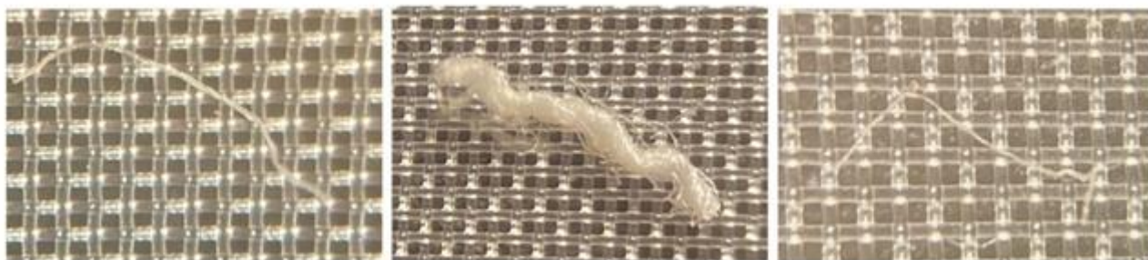
Рисунок 3.13 – Частицы микропластика белого и прозрачного цвета обнаруженные в Азовском море (фото со стереомикроскопа Микромед МС-1 вар. 2C Digital)
