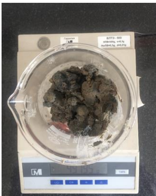
Рисунок 3.8 – Взвешивание высушенной пробы донных осадков
