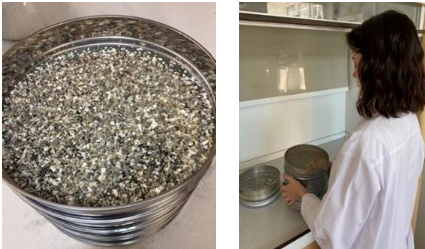
Рисунок 3.6 – Просеивание образцов пляжевых отложений Азовского моря
