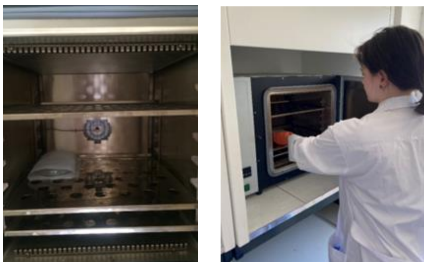
Рисунок 3.11 – Сушка отобранных проб в лабораторном сушильном шкафу при температуре 80°C
