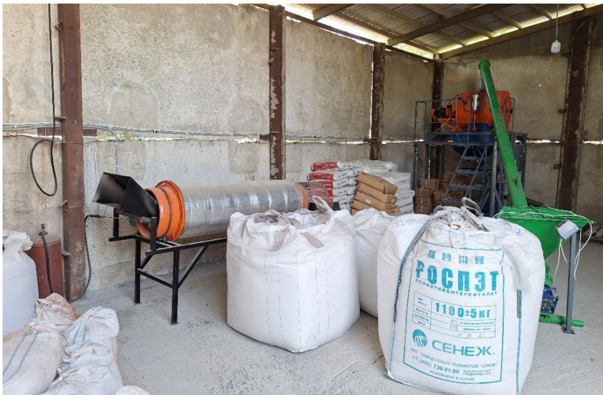
Рисунок 5.1 – Технологическая линия для производства сухих ремонтно-реставрационных смесей
