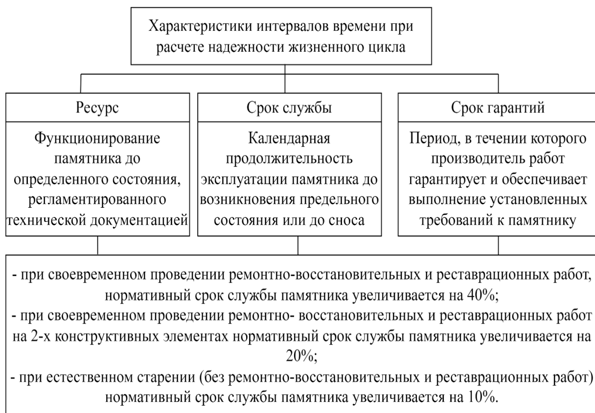
Рисунок 2.13 – Характеристики интервалов времени при расчете надёжности жизненного цикла памятника истории и культуры башенного типа
