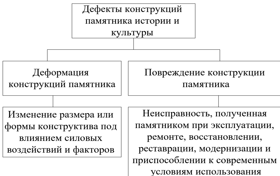
Рисунок 1.19 – Дефекты конструкций памятника истории и культуры башенного типа
