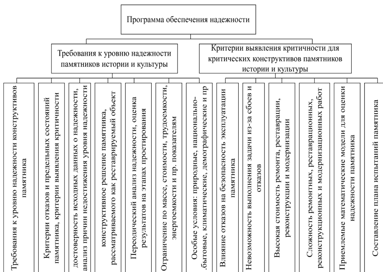
Рисунок 3.3 – Программа обеспечения надежности памятника истории и культуры башенного типа на этапе проектирования жизненного цикла
