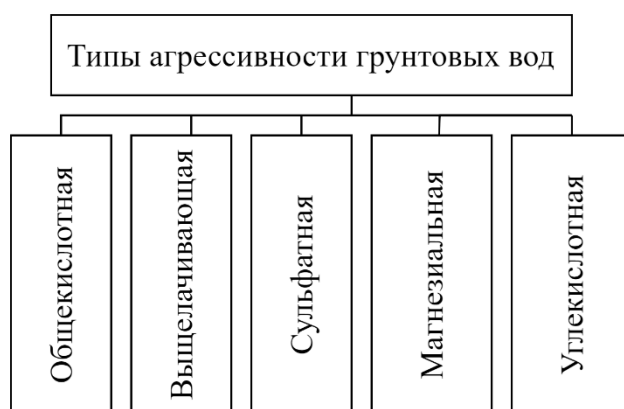
Рисунок 2.15 – Типы агрессивности грунтовых вод в соответствии со СНиП 2.03.11-85
