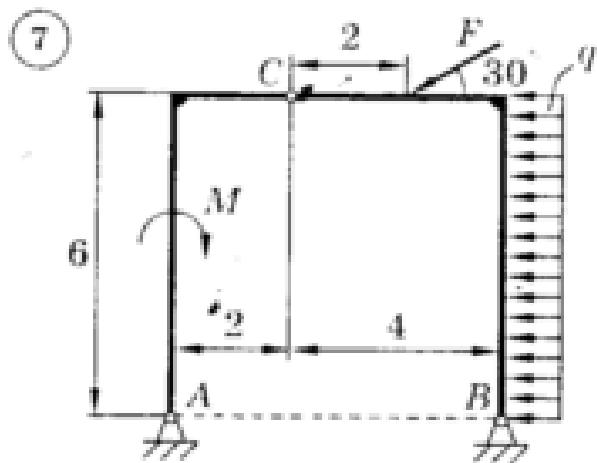
$M = 30 \text{ kH}\cdot\text{m}$ ;  $q = 10 \text{ kH}/\text{m}$ ;
