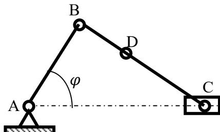
$$\begin{aligned}AB &= 60 \text{ мм}, \\BC &= 180 \text{ мм}, \\BD &= 25 \text{ мм}, \\&\varphi = 40^\circ,\end{aligned}$$
