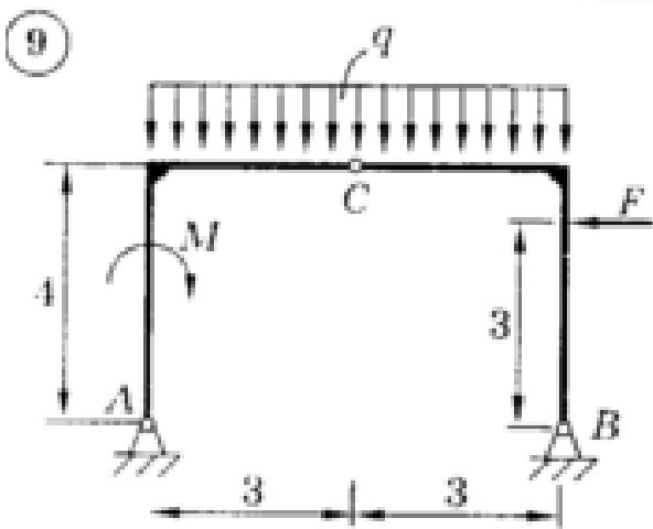
$M = 60 \text{ kH}\cdot\text{m}$ ;  $q = 20 \text{ kH}/\text{m}$ ;
