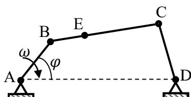
$$\begin{aligned}AB &= 70 \text{ мм}, \\AD &= 180 \text{ мм}, \\BC &= 112 \text{ мм}, \\CD &= 60 \text{ мм}, \\BE &= 30 \text{ мм}, \\&\varphi = 45^\circ,\end{aligned}$$
