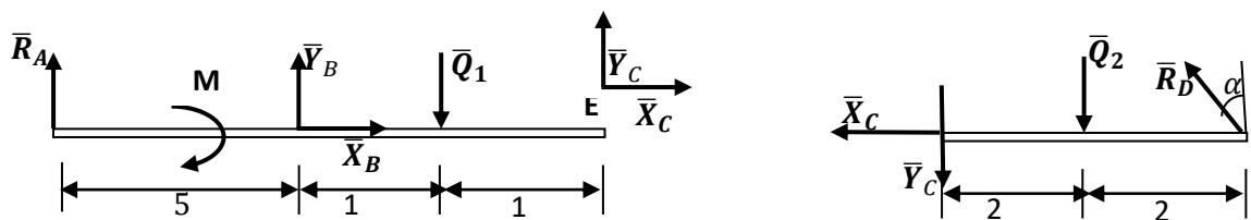
При направлении составляющих  $\bar{X}_c$  и  $\bar{Y}_c$  для левой и правой балок учтён принцип равенства действия и противодействия. Выделенные силы:
