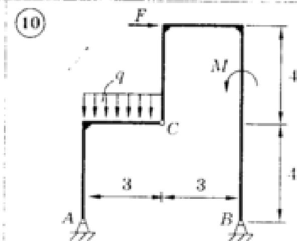
$M = 30 \text{ kH}\cdot\text{m}$ ;  $q = 10 \text{ kH}/\text{m}$ ;
