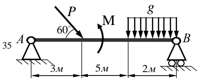
на которую действует внешняя нагрузка  $P = 5 \text{ кН}$ ,  $g = 2 \text{ кН/м}$
