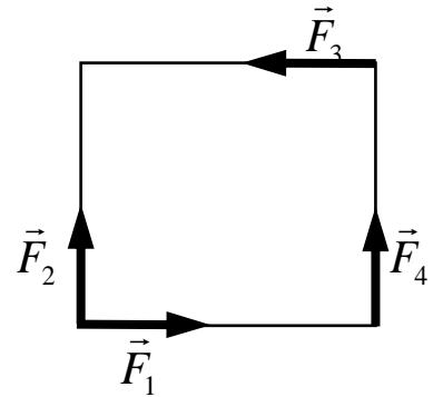
4. К квадрату приложена система четырёх сил, причём силы  $F_1 = F_2 = F_3 = 1H$ . Определить модуль силы  $F_4$ , при которой равнодействующая системы  $R = 2H$ .
