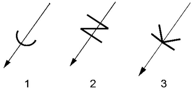
8 Сварной шов, выполненный по замкнутому контуру, на чертеже показывают ...
