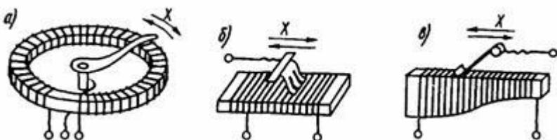
Рисунок 3.1 – Реостатные преобразователи для угловых и линейных перемещений
